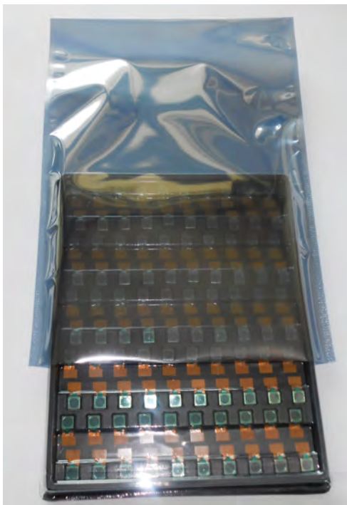
In Antistatikbeutel stecken
